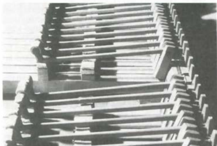
Abb. 4: Prellungenmechanik des Hammerflügels der Gebrüder Gräbner von 1794 (Händel-Haus Halle).
