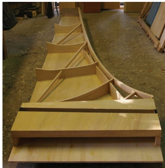
ill. 22, costruzione interna della copia del clavicembalo d'ebano di Cristofori
