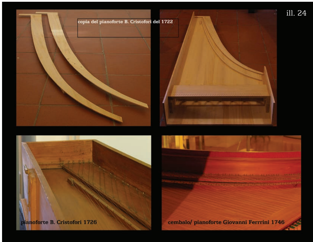
ill. 23, la costruzione della doppia fascia curva, copia del pianoforte Cristofori del 1722
