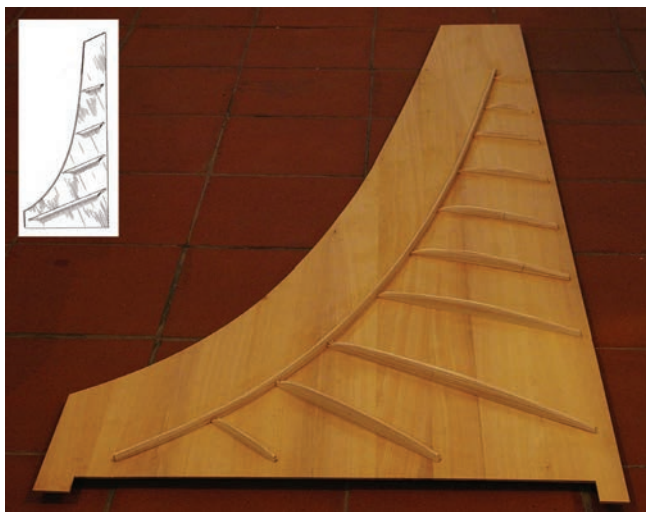
ill. 25, le catene, copia del pianoforte Cristofori del 1722
