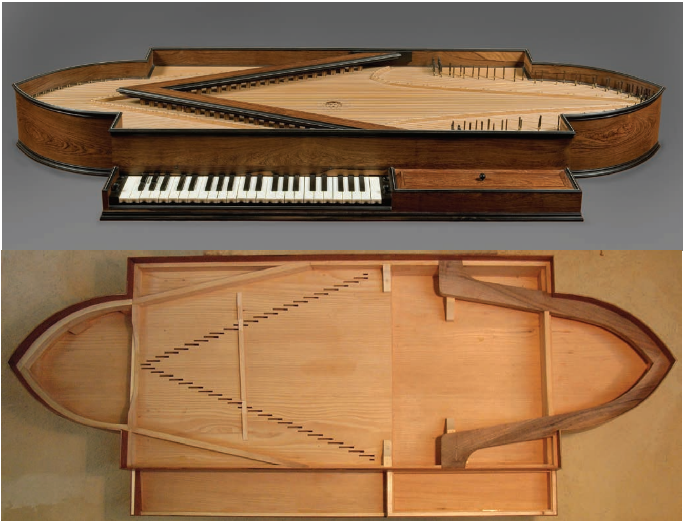
ill. 12a, 12b la copia e la costruzione interna della copia della spinetta ovale del 1690
