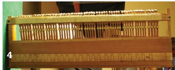
3, 4, telaio dei martelletti, pianoforte Cristofori 1720
