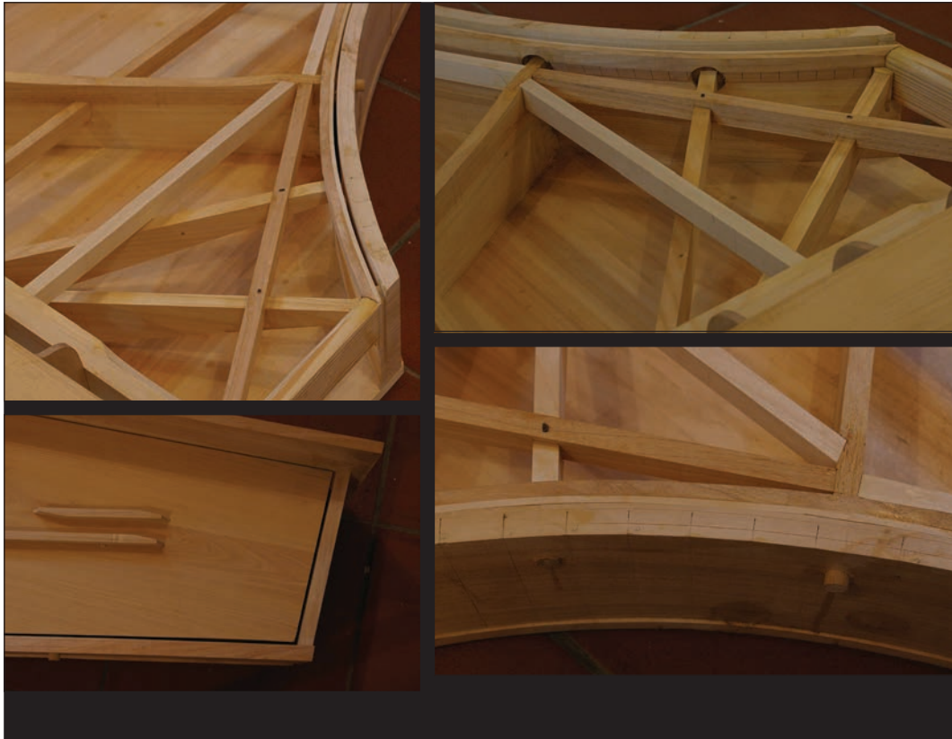
ill. 23, la costruzione della doppia fascia curva, copia del pianoforte Cristofori del 1722
